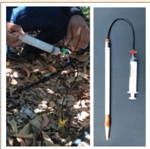
Instalação de extratores de solução de solo para manejo da fertirrigação.
