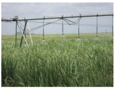
Sistema Linear com aspersores tipo LEPA, irrigando cana-de-açúcar
