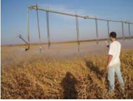
Aferição de pressão na extremidade de um pivô central
