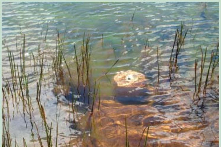
Figura 6 – Barril – parte do infiltrômetro – instalado no fundo do reservatório da barragem.
