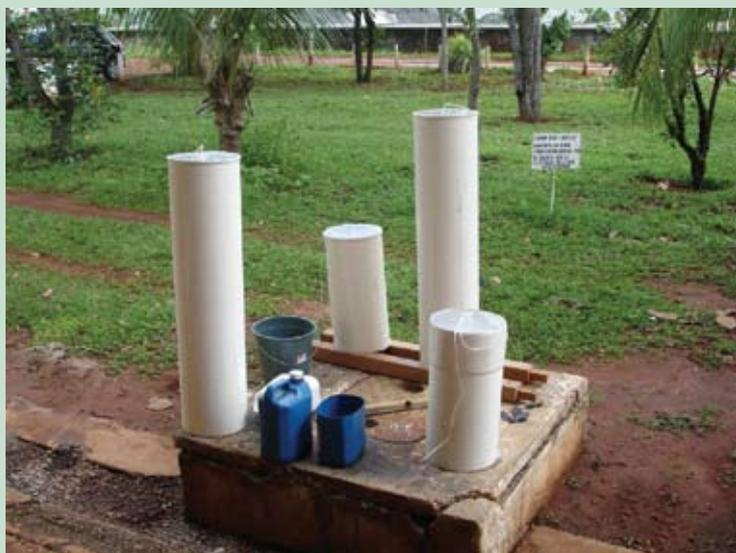
Figura 4 – Detalhe de infiltrômetros com diferentes alturas.
